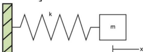
Considerăm o masă  $m$  atașată unui arc, căreia îi aplicăm o forță  $f$  (intrarea) în direcția opusă arcului. Măsurăm poziția  $x$  a masei relativ la poziția de repaus a arcului (ieșirea). Din legea a doua a lui Newton:
