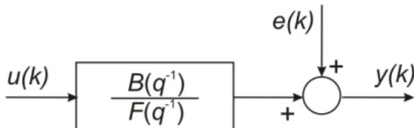
Structura corespunde unui zgromot simplu, aditiv la ieșire (de unde reiese și numele).
